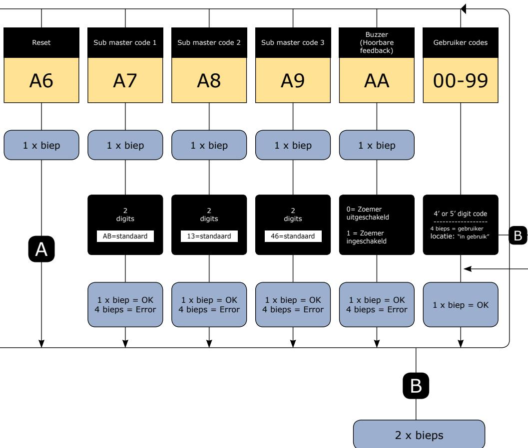
**GALEO 4.0 Bluetooth***Weerbestendig verlicht toetsenbord met gescheiden elektronica***7] PROGRAMMERING****A. EERSTE GEBRUIK OF NA EEN RESET**
