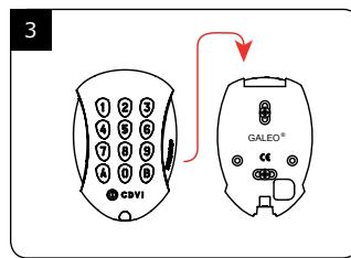
Controleer de afstand tussen de GALEO en de gescheiden elektronica (zie pagina 9 «Herinneringen en aanbevelingen»). Gebruik de gescheiden elektronica bevestigingsplaat en de GALEO om markeringen te maken en de 2 bevestigingsgaten te boren (bos Ø 5 mm en minimum diepte = 35 mm). Ten slotte de opening voor de doorgang van de elektrische kabel voor het toetsenbord.
