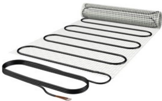
La natte chauffante DSN se compose d'un treillis en fibre de verre sur lequel un câble de chauffage à isolation extérieure résistante aux UV est cousu (pour toits en feuilles et en tôles). Elle protège les toits, gouttières et bâtiments contre la dégradation liée au poids de la neige.
