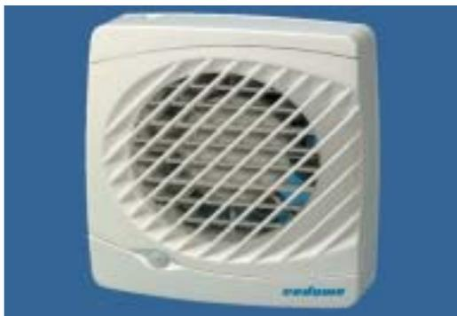
Le ventilateur AX100PIR inclut dans sa structure une sonde à détection infra-rouge. D'un design élégant, il est commandé par la détection de présence d'une personne dans le local à ventiler (7 mètres max.). La période de fonctionnement du ventilateur après sa mise en route peut être réglée jusqu'à 25 minutes.
