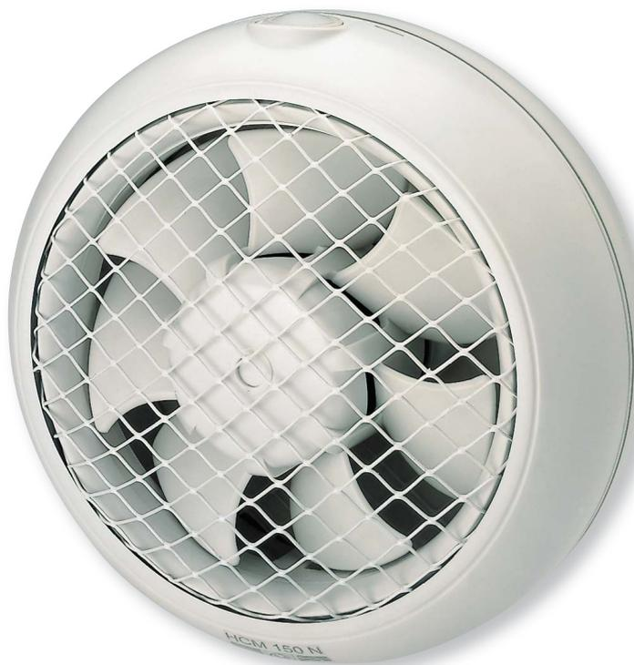
Gamme d'aérateurs hélicoïdes conçus pour le renouvellement d'air dans les locaux domestiques ou tertiaire. Virole en plastique injecté. Grille de protection à l'aspiration et soufflage. Volet de fermeture au soufflage. Hélice profilée en plastique injecté. Tous les aérateurs sont classe II, IPX4.
