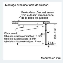
Si l'appareil compact est installé sous une table de cuisson, les épaisseurs de plaque de travail suivantes (le cas échéant y compris la sous-structure) doivent être respectées.
