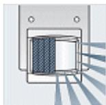
Angle de détection limitable individuellement grâce au placement de caches enfichables joints
