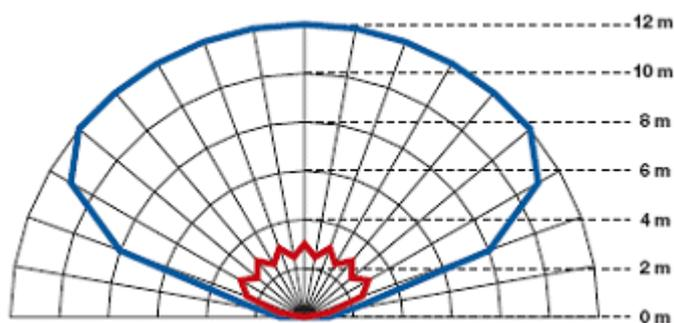
Zone de détection IS 2160, hauteur d'installation 1,8 m
