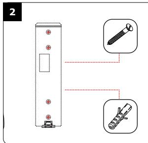
Steek de ankerpluggen in de bogen, plaats de montageplaat op de muur, zodat de bevestigingsgaten overeenstemmen met de bogen, en Schroef de montageplaat vast met de meegeleverde schroeven (M4x30)
