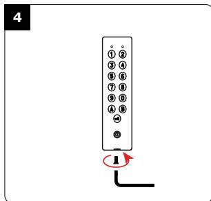
Bevestig het codeklavier met de meegeleverde Torx schroef (M5x8) en het T20 Torx gereedschap. Plaats hierna het afdekplaatje over de schroef.
