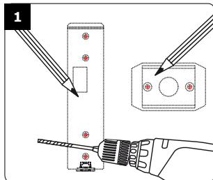
Vérifiez la distance entre le PROFIL100EC et son électronique déportée (Voir page 2 « Rappels et recommandations »). A l'aide de la plaque de fixation de l'électronique déportée et du PROFIL100EC, prenez les marques et percez les 2 trous de fixation (forêt Ø 5 mm et profondeur minimum = 35 mm) ainsi que l'ouverture pour le passage du câble électrique destiné au clavier.
