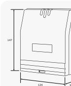
Electronique déportée, fournie avec le clavier codé PROFIL100EC
