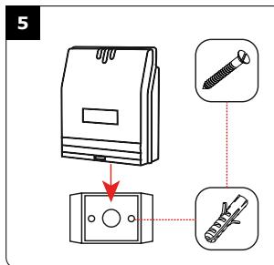
Steek de 2 anker pluggen in de bogen. Plaats de montagebeugel op de muur zodat de montagegaten overeenkomen met de bogen. Schroef de beugel vast met de meegeleverde schroeven (M4x30). Glij de doos van de gescheiden elektronica over de beugel, zodat de gleuven van de doos over de beugel komen.
