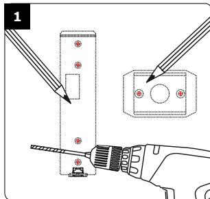
Controleer de afstand tussen de PROFIL100EC en de gescheiden elektronica (zie punt 2, opmerkingen en aanbevelingen). Plaats de montageplaat van de PROFIL100EC, en de montagebeugel van de elektronica op de muur en teken de boringen af. Maak de boringen met een boor van 5mm, 35mm diep. Vergeet de boring voor de bekabeling niet.
