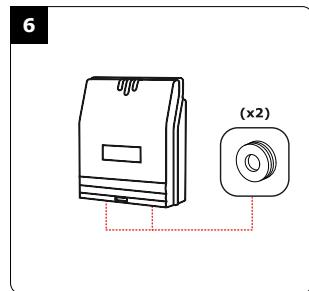
Steek de bekabeling in de doos van de gescheiden elektronica. Sluit de draden op de klemmen aan. Vergeet niet om de meegeleverde varistor op het elektro-slot te plaatsen (zie punt 2, opmerkingen en aanbevelingen)
