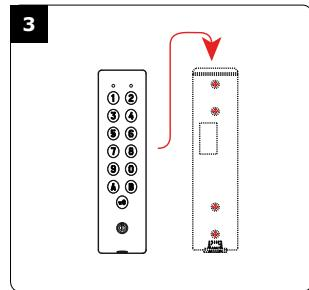
Steek de kabel door het daarvoor voorziene gat in de montageplaat. Plaats het codeklavier op de montageplaat door eerst de bovenkant in te haken.
