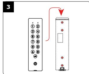
Passer le câble électrique dans le PROFIL100EC dans son ouverture et fixez le à son support par le haut avec le crochet supérieur.
