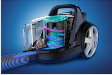
Grâce à son design aérodynamique, le PowerCyclone 7 minimise la résistance à l'air et offre des performances de nettoyage exceptionnelles en 3 étapes ultra-efficaces : 1) L'air s'introduit rapidement dans le PowerCyclone grâce à une arrivée d'air droite et lisse. 2) La conduite courbée dirige l'air vers le haut et augmente sa vitesse dans la chambre cyclonique. 3) Au sommet du cyclone, les lames de sortie séparent efficacement la poussière de l'air.
