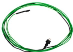
ETHERMA ICESTOP protège les conduites contre la glace et les dommages consécutifs. ICESTOP est un câble de chauffage prêt à enficher, d'une puissance constante de 10 W/m env. Le thermostat est protégé contre l'humidité jusqu'à 100 %, tandis que la protection antigel s'enclenche à des températures inférieures à +3°C et se désactive au-dessus de +9°C. **ADAPTÉ UNIQUEMENT AUX CONDUITES MÉTALLIQUES.**
