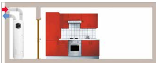
AIR EXTÉRIEUR AVEC GAINÉ POUR NE PAS REFFROIDIR LA PIÈCE (DANS UN VOLUME CHAUFFÉ)
