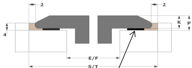
Joint d'étanchéité 2mm
