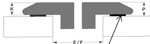
Joint d'étanchéité 2mm
