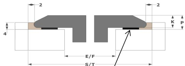
Joint d'étanchéité 2mm
