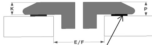
Joint d'étanchéité 2mm
